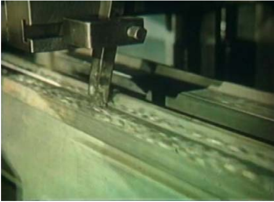
Figura 6: la barra raspa el metal
